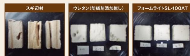
石膏上にネットを敷き試験体を設置した後に、イエシロアリ職蟻15頭を投入して、3週間にわたって強制摂食させました。スギ辺材や防蟻剤添加無しのウレタンは、シロアリによって大きな穴を開けられています。しかし、フォームライトSL-100ATでは殆ど食害はみられませんでした。(写真内に見られる黒点は、アリの糞や唾液の痕です)
